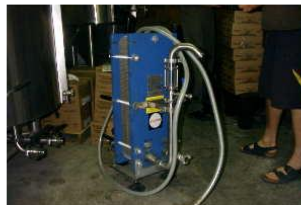
（上）電気ヒーター、（下）熱交換器
